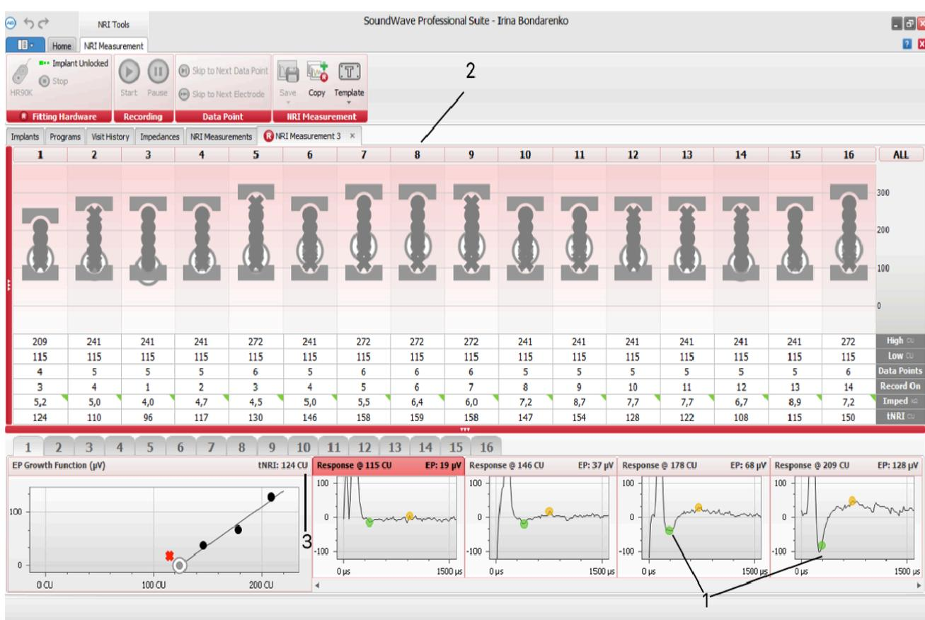
Рис. 5. Электрически вызванный потенциал действия слухового нерва (ЭВПДСН), зарегистрированный методом ТНО при использовании программного обеспечения SoundWave 3.0 («Advanced Bionics»): 1 – потенциал действия слухового нерва; 2 – номер электрода; 3 – единица стимуляции в С.
